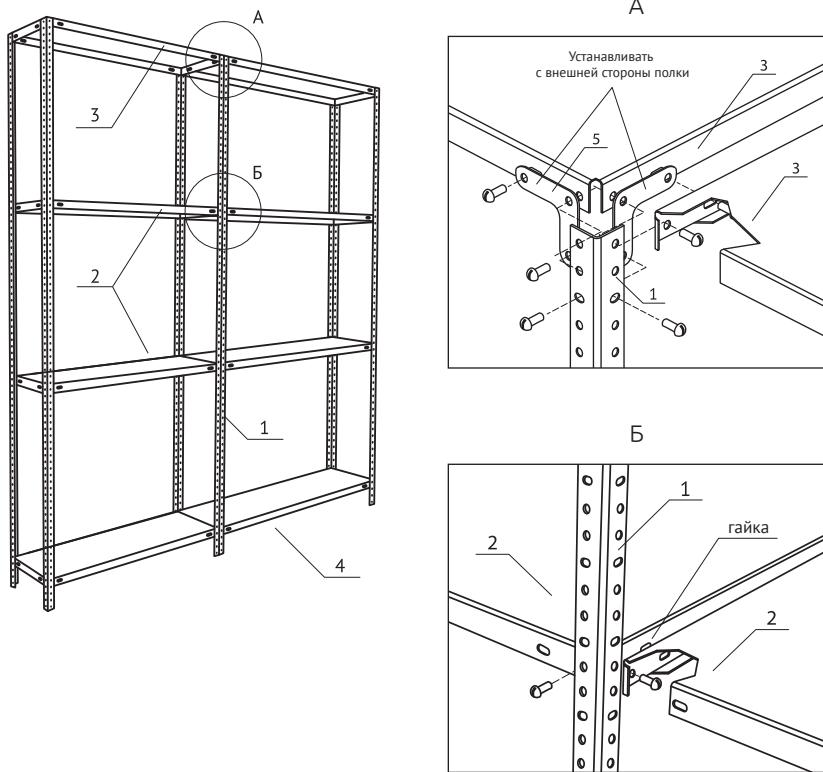
Рис. 3. Сборка стеллажа серии ТС ленточным способом.
