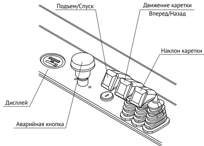
На панели управления находятся дисплей, кнопка аварийного выключения питания, рычаги управления.
