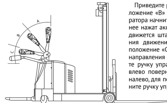
Приведите ручку управления в положение «В» и при помощи акселератора начните движение. Чем сильнее нажат акселератор, тем быстрее движется штабелер. Для прекращения движения приведите ручку в положение «С» или «А». Для выбора направления движения используйте ручку управления. Для поворота влево поверните ручку управления налево, для поворота вправо поверните ручку управления направо.
