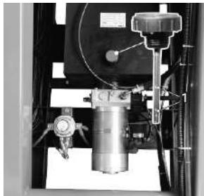
Для проверки уровня масла используйте масляный щуп. Щуп предназначен для контроля уровня масла в гидравлической системе. Уровень масла должен находиться между двумя засечками (1) на масляном щупе.
