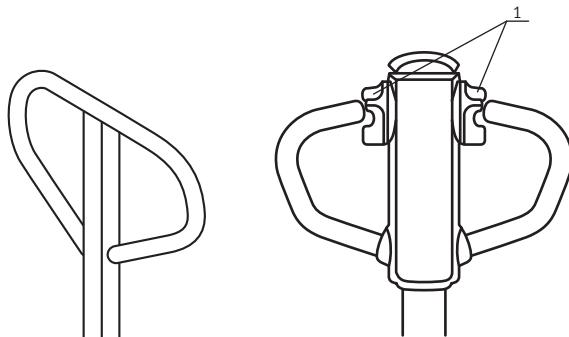
Перемещение несамоходного ножничного подъемника SMART SJY ручное. Используйте для перемещения ручку управления, расположенную на нижней раме ножничного подъемника.
