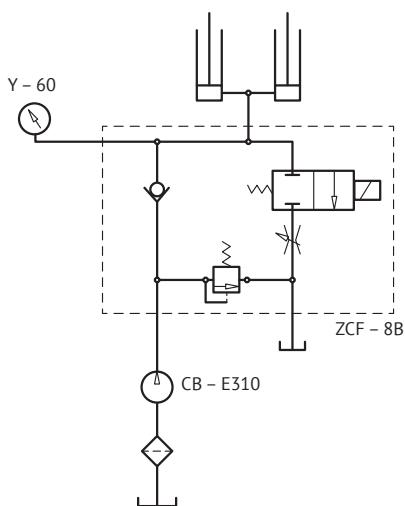
Рисунок внутри пунктирной линии показывает только основной принцип работы системы. Гидравлический клапан разработан заводом-изготовителем специально для Гидравлического подъемника с учетом его потребностей.
