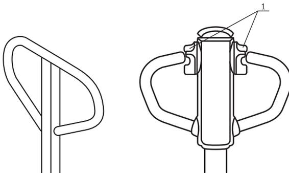
Перемещение несамходного ножничного подъемника SMART SJY ручное. Используйте для перемещения ручку управления, расположенную на нижней раме ножничного подъемника.
