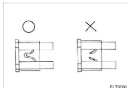
Проверьте и при необходимости замените предохранители, ориентируясь на рисунок. Если предохранитель выглядит как в части помеченной «X», замените его на новый. Новый предохранитель должен соответствовать характеристикам указанным ниже
