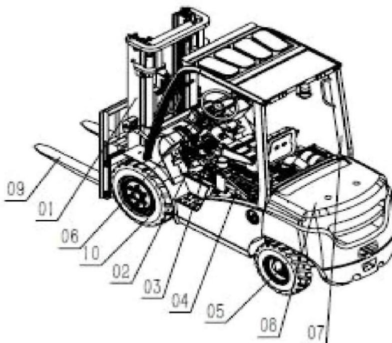
1. Мачта; 2. Гидротрансформатор; 3. Гидравлическая трансмиссия; 4. Двигатель;
