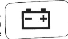
Если этот индикатор не гаснет, возможно, что-то не так с системой заряда. В таком случае, пожалуйста, предоставьте погрузчик для проверки и ремонта агентам.
