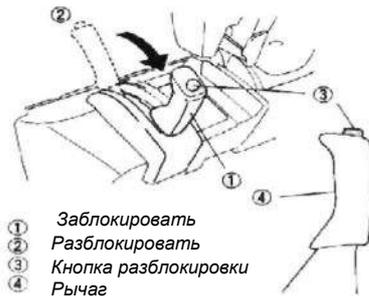
Потяните этот рычаг (4) на себя до упора (1), чтобы затормозить погрузчик. Чтобы отпустить стояночный тормоз (2), нажмите кнопку разблокировки (3). Работая с этим рычагом, нажимайте на педаль тормоза.
