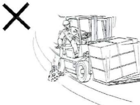
✧ Не включайте механизм бокового смещения, если он установлен, когда вилы подняты и загружены, так как это приведет к разбалансировке погрузчика.
