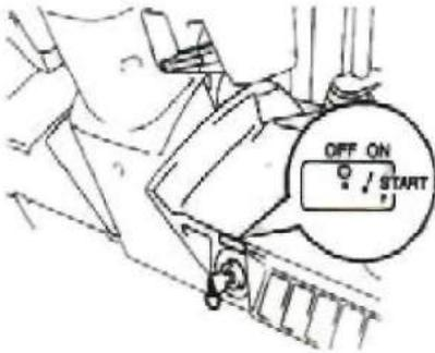
[OFF]..... это положение, при котором двигатель останавливается. В этом положении ключ можно вставлять и вытаскивать.
