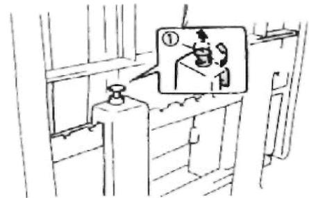
После регулировки поверните фиксатор, чтобы заблокировать вилы на грузовой каретке.
