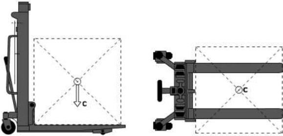
При работе с грузом не устанавливайте груз на концы вилок, не перевозите неустойчивый или плохо размещенный груз во избежание его падения. Будьте осторожны и внимательны при подъеме и опускании груза. При движении с грузом вилы следует опустить как можно ниже. При работе со штабелером никогда не стойте под вилами и не вставайте на них во избежание травм.
